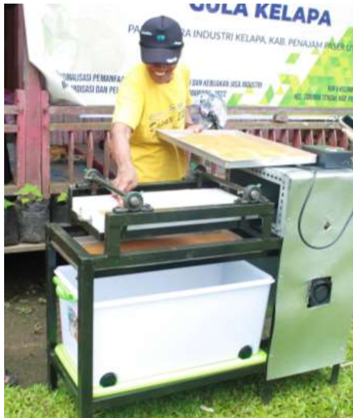
Gambar 4. Rancangan Alat Pengering Tenaga Listrik
